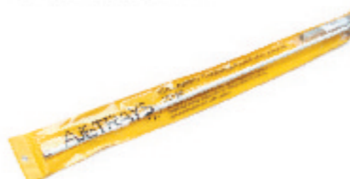
VH-50 / UH-50 Базовая антенна VHF 136-174 МГц 4.5 dB UHF 400-480 МГц 6.5 dB Длина антенны: 1.75м / 1.5 м Излучающий элемент: 1x5/8 L / 1x5/8 L
